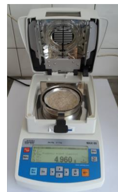
Rys. 1. Stanowisko do oznaczania wilgotności z wykorzystaniem wagosuszarki Radwag MAX 60
