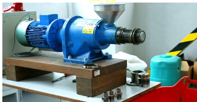
Fot. 2. Prasa do badania efektywności wyłaczania oleju Fot. 2. Press for evaluating oil extraction efficiency
