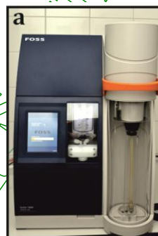
Rys. 6. a - Automatyka jednostka do oznaczania tłuszczu całkowitego Soxtec 8000; b - System automatycznej analizy azotu Kjeltex 8400
