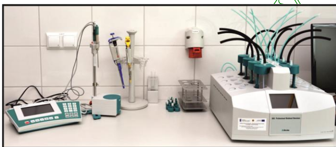
Rys. 4. Aparat do oznaczania stabilności oksydacyjnej Rancimat Fig. 4. Rancimat for determination of the oxidation stability
