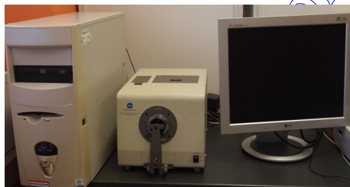
Rys. 4. Stanowisko do pomiaru barwy – spektrofotometr Konica-Minolta Fig. 4. Color measurement set – spectrophotometer Konica-Minolta
