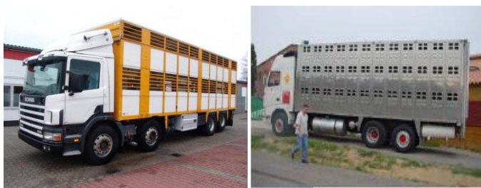
Rys. 1. Transportery samochodowe dwu- i trójpoziomowy do przewozu świń ( http://www.acr-juretzki.de/ )
