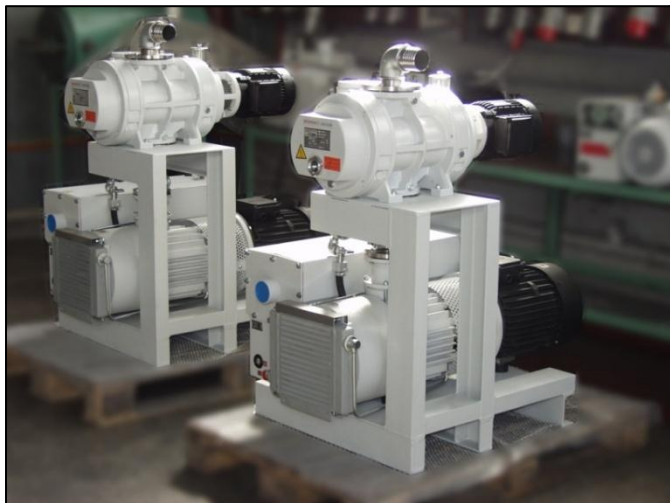
Rys. 1. Stanowiska próżniowe SR-500 o wydajności 500 \text{ m}^3 \cdot \text{h}^{-1} - przykładowy zespół pompujący systemu próżni centralnej
