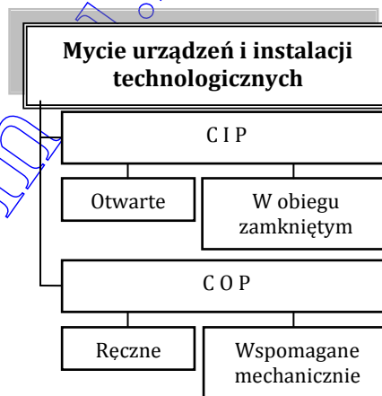
Rys. 6. Metody i techniki mycia urządzeń i instalacji technologicznych Fig. 6. Methods and techniques of washing machines and installations
