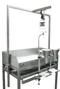
Rys. 1. a - Stół do wspomagania higienicznego pakowania kapusty kiszonej; b - Przejezdna wywrotnica kanistrów, hoboków itp. opakowań
