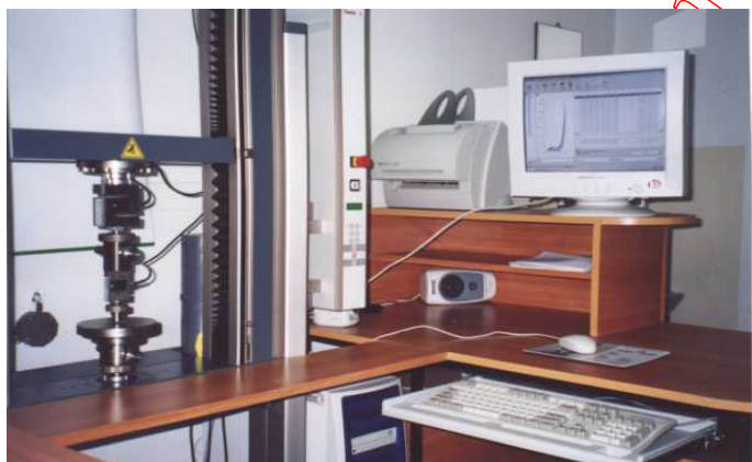
Maszyna wytrzymałościowa Zwick do badań właściwości mechanicznych i technologicznych materiałów i produktów spożywczych
