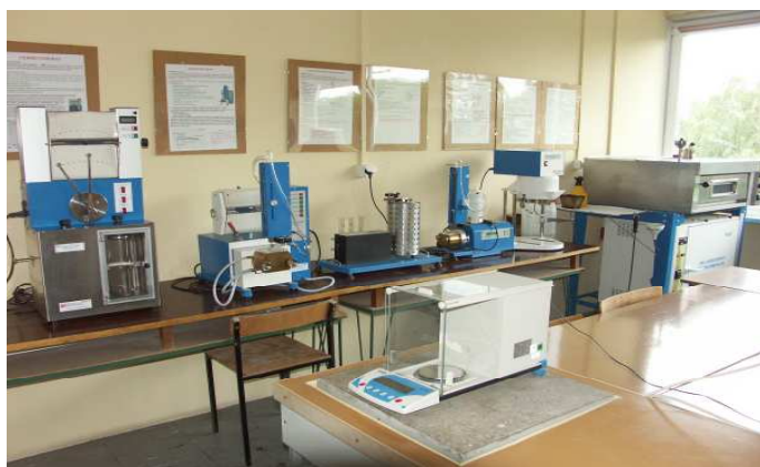
Urządzenia do pomiaru właściwości mąki, ciasta i wypieku – fermentograf, konsystograf, aparaty do oznaczania liczby opadania oraz wodochłonności ciasta, mieszarka, piec laboratoryjny
