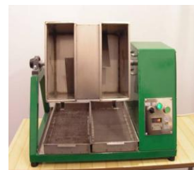
Stanowisko do separacji oraz tester do pomiaru trwałości kinetycznej.
