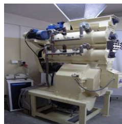
Stanowiska do badania procesów aglomeracji ciśnieniowej.
