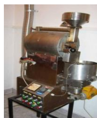
Prażak do obróbki termicznej i hydrotermicznej surowców zbożowych i laboratoryjny mikronizator.
