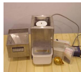
Stanowisko do separacji oraz tester do pomiaru trwałości kinetycznej.
